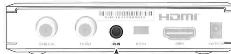
IR Port for IR Extender
